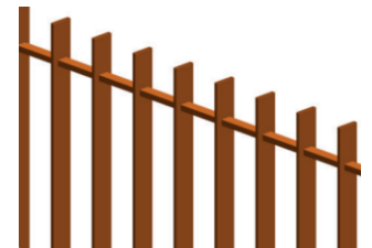
Remplissage barreaux plats dépassants
